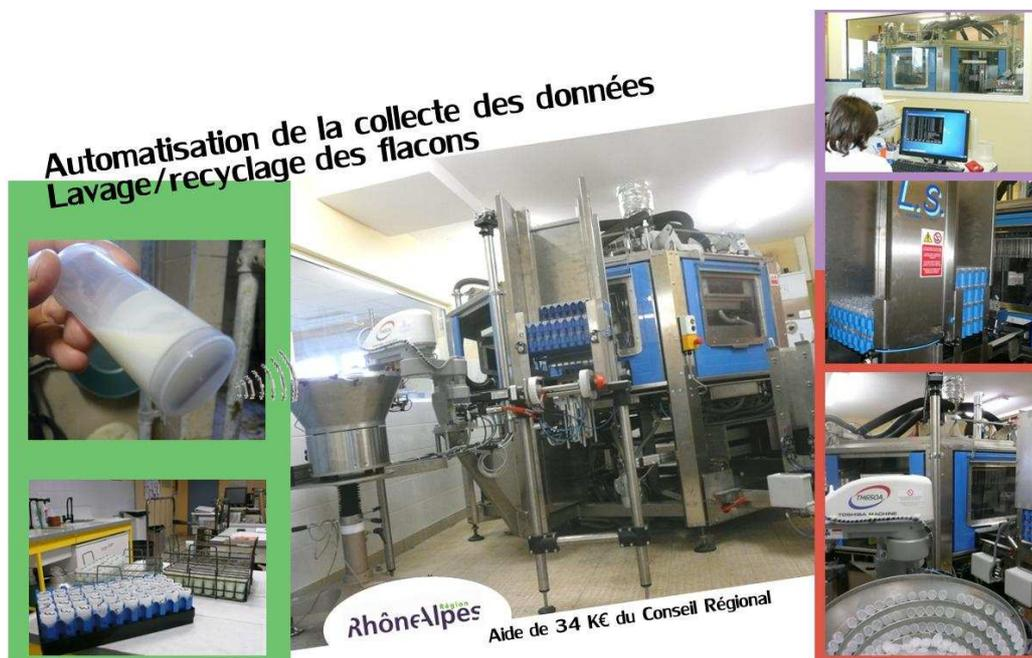
Un automate de lavage est arrivé depuis quelques semaines au laboratoire et va permettre de laver, recycler aussi bien les flacons jetés jusqu'à ce jour après usage unique que les prochains flacons RFID lorsque nous déploierons la liste de pesées électronique.
